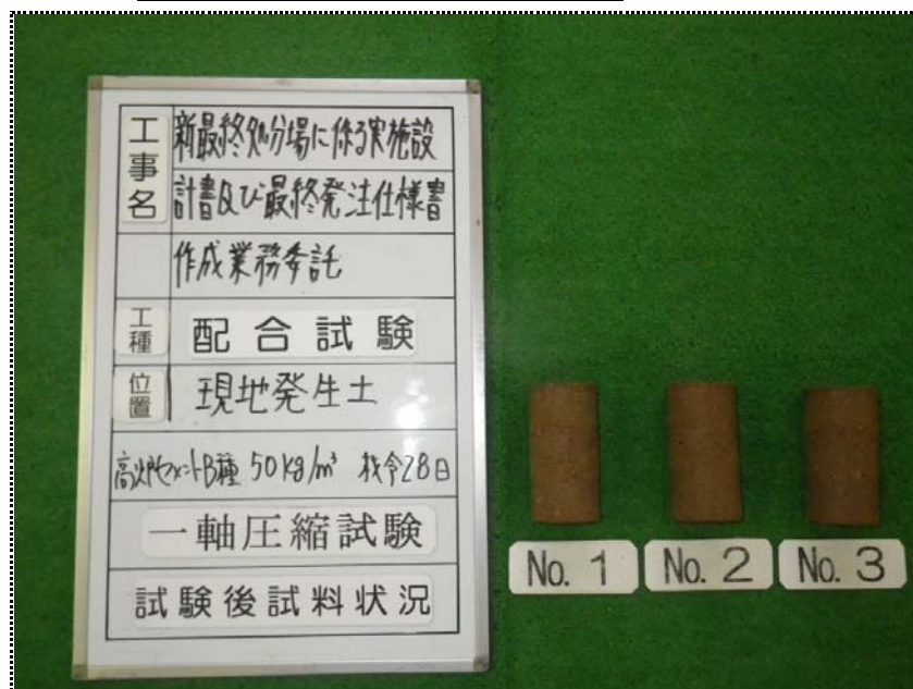
一軸圧縮試験（試験後試料状況） 50kg/m³（材令28日）
