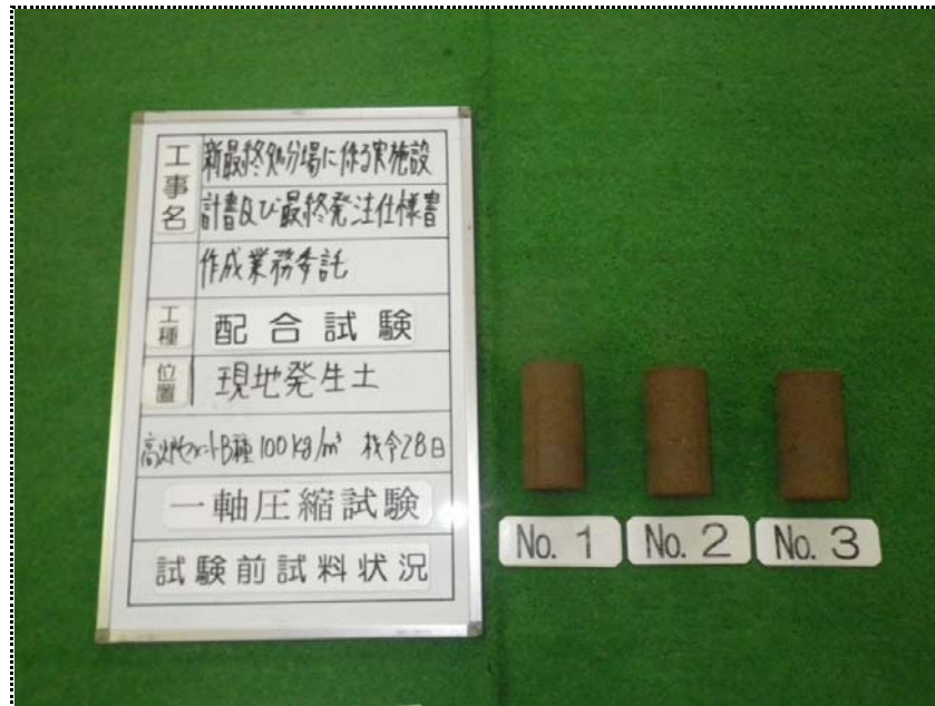
一軸圧縮試験（試験前試料状況） 100kg/m³（材令28日）
