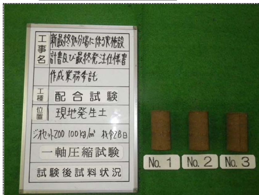
一軸圧縮試験 (試験後試料状況) 100kg/m³ (材令28日)
