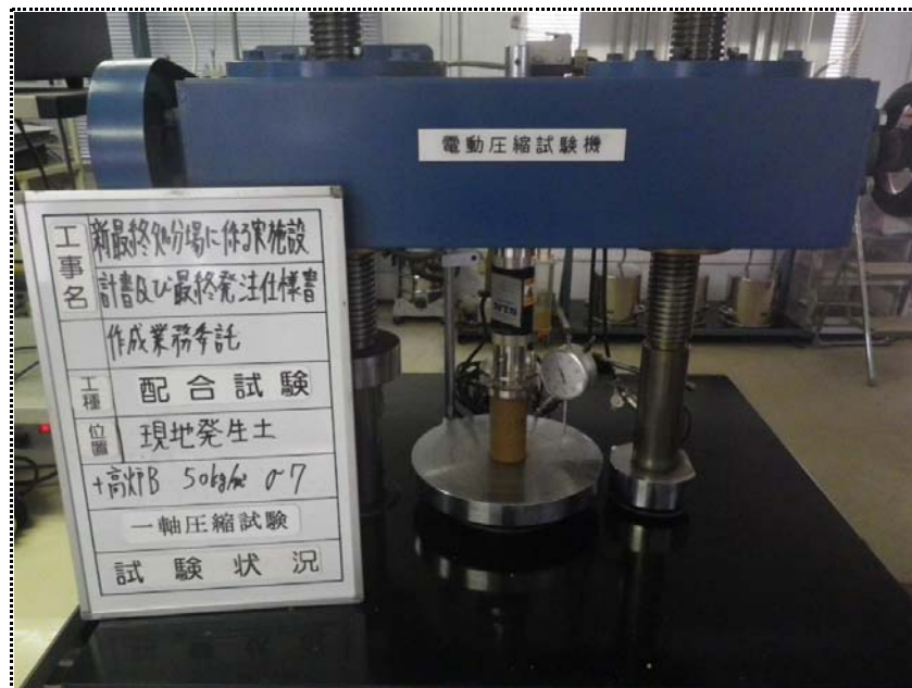
一軸圧縮試験（試験状況） 50kg/m 3 （材令7日）
