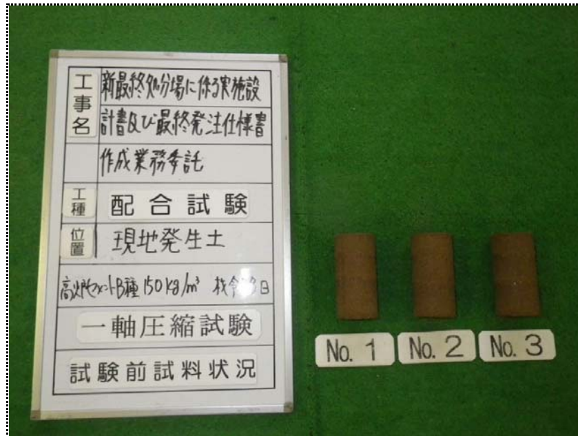
一軸圧縮試験（試験前試料状況） 150kg/m³（材令28日）
