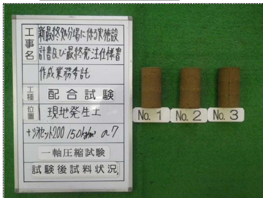
一軸圧縮試験 (試験後試料状況) 150kg/m 3 (材令7日)
