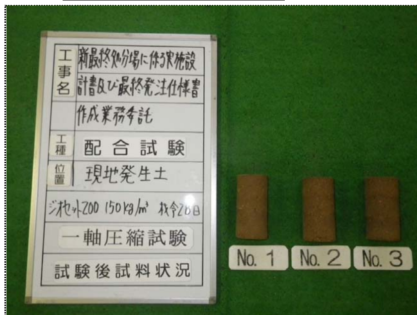
一軸圧縮試験 (試験後試料状況) 150kg/m 3 (材令28日)
