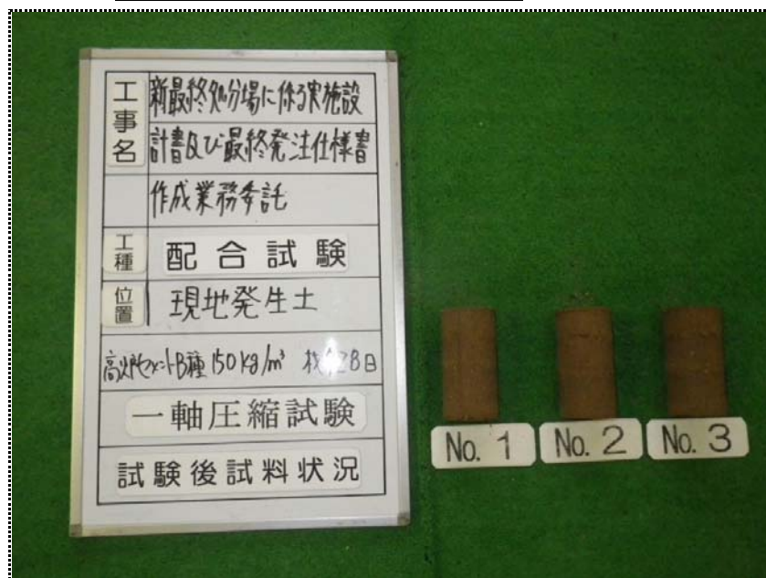
一軸圧縮試験（試験後試料状況） 150kg/m³（材令28日）
