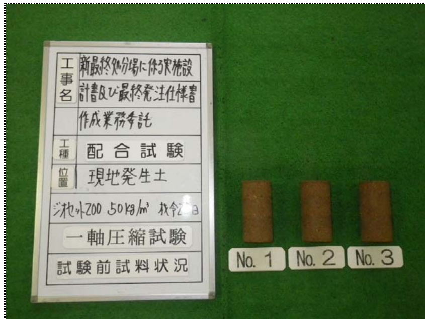
一軸圧縮試験 (試験前試料状況) 50kg/m³ (材令28日)
