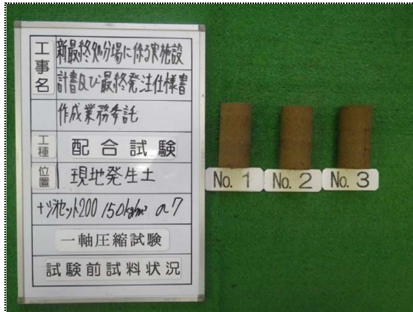
一軸圧縮試験 (試験前試料状況) 150kg/m 3 (材令7日)
