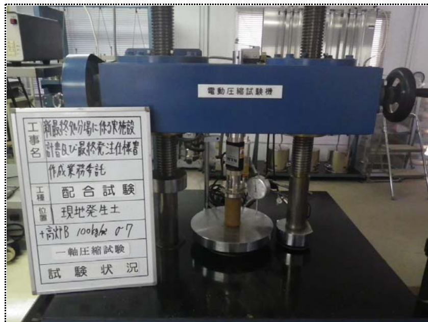
一軸圧縮試験（試験状況） 100kg/m 3 （材令7日）
