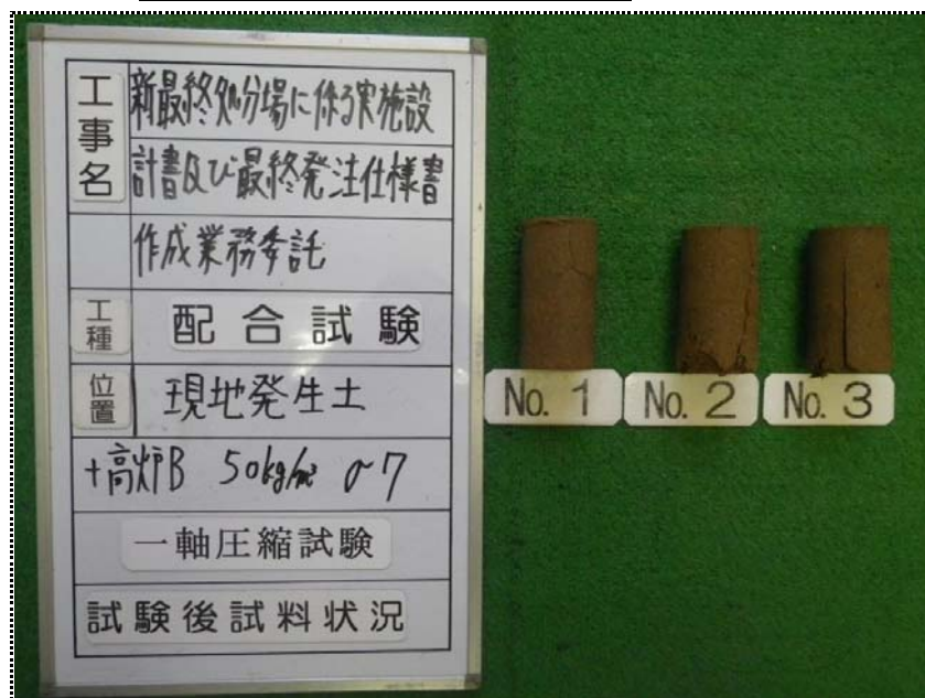
一軸圧縮試験（試験後試料状況） 50kg/m 3 （材令7日）
