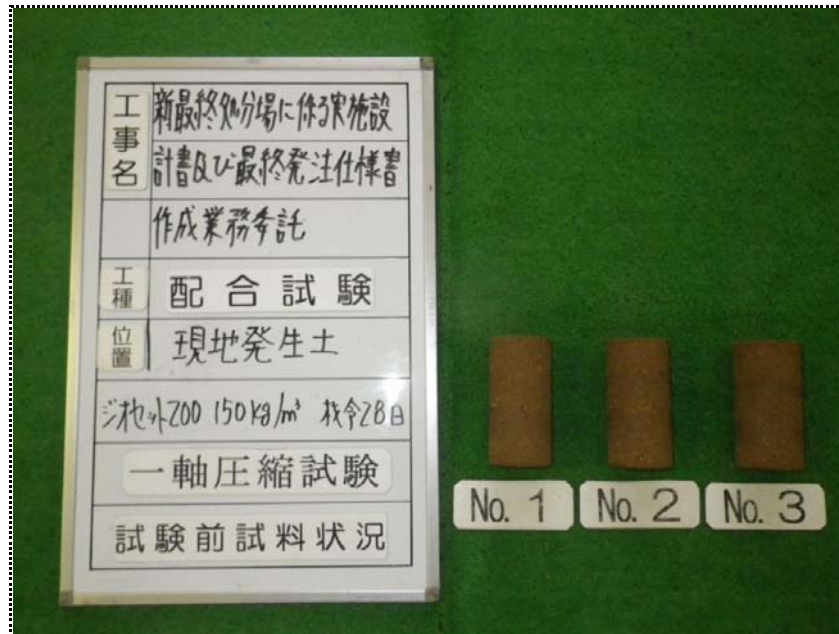
一軸圧縮試験 (試験前試料状況) 150kg/m 3 (材令28日)
