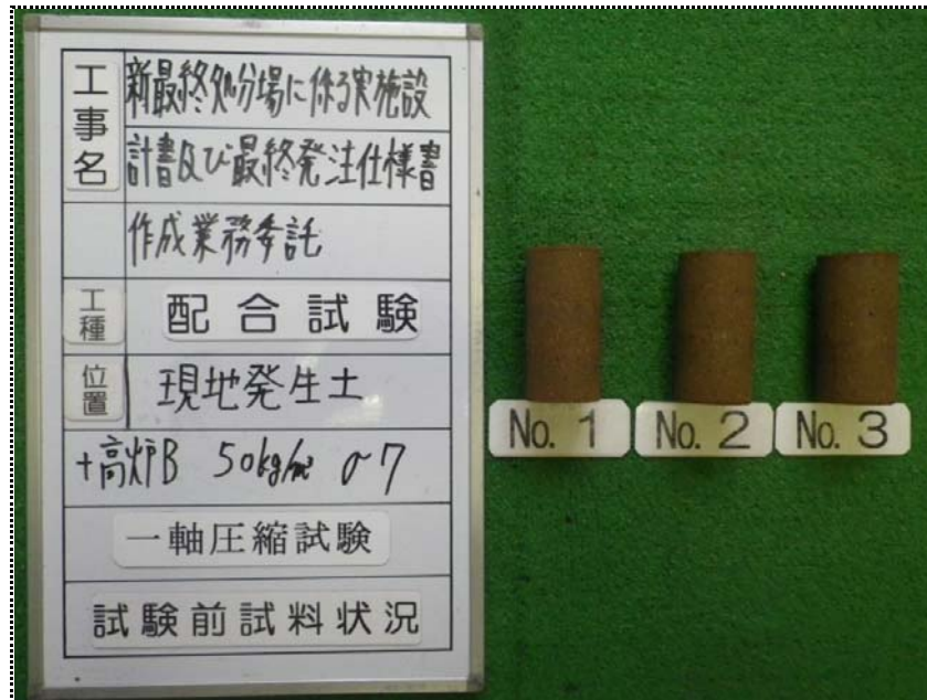
一軸圧縮試験（試験前試料状況） 50kg/m 3 （材令7日）
