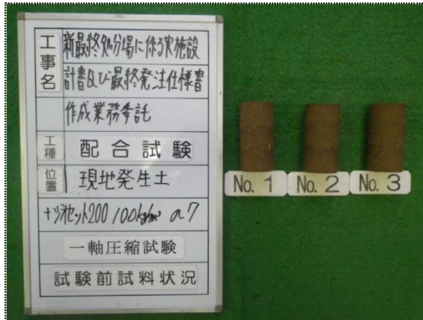
一軸圧縮試験 (試験前試料状況) 100kg/m 3 (材令7日)
