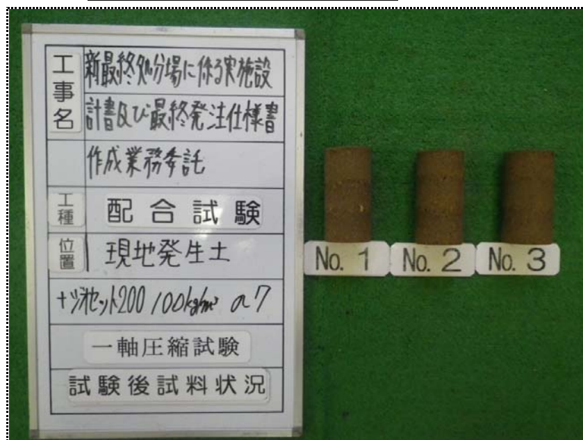
一軸圧縮試験 (試験後試料状況) 100kg/m 3 (材令7日)
