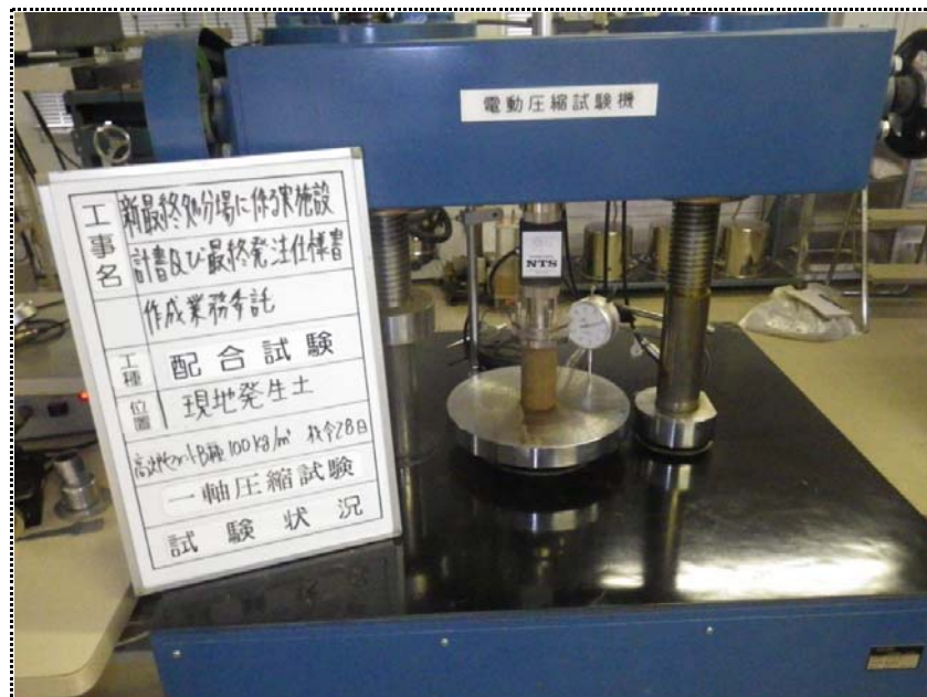
一軸圧縮試験（試験状況） 100kg/m³（材令28日）
