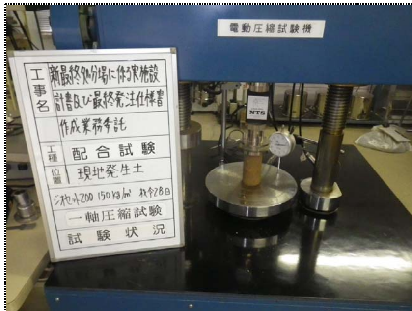
一軸圧縮試験 (試験状況) 150kg/m 3 (材令28日)
