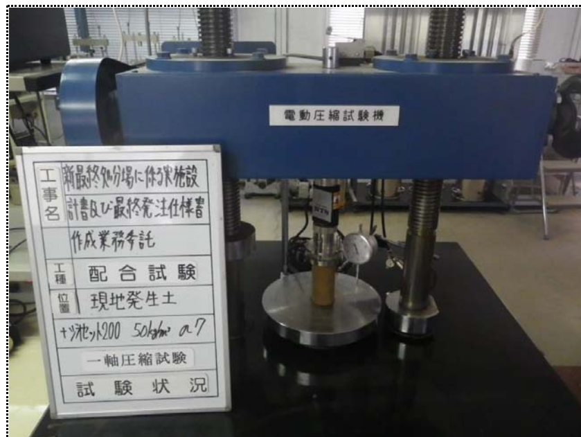
一軸圧縮試験 (試験状況) 50kg/m³ (材令7日)
