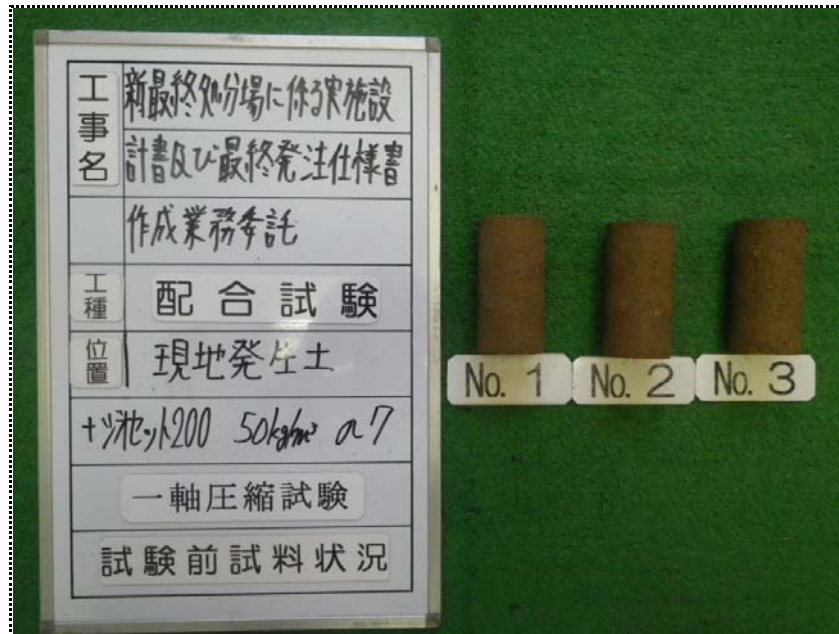
一軸圧縮試験 (試験前試料状況) 50kg/m³ (材令7日)
