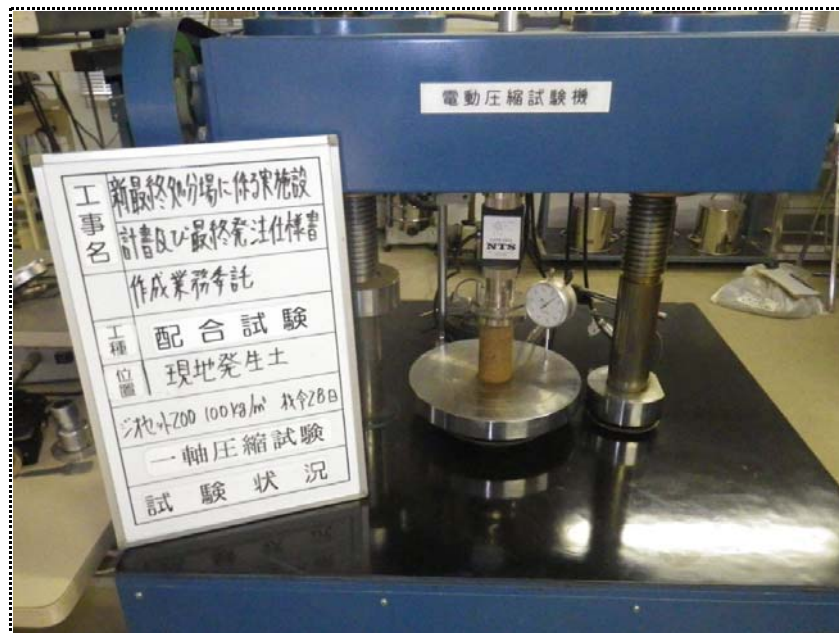
一軸圧縮試験 (試験状況) 100kg/m³ (材令28日)
