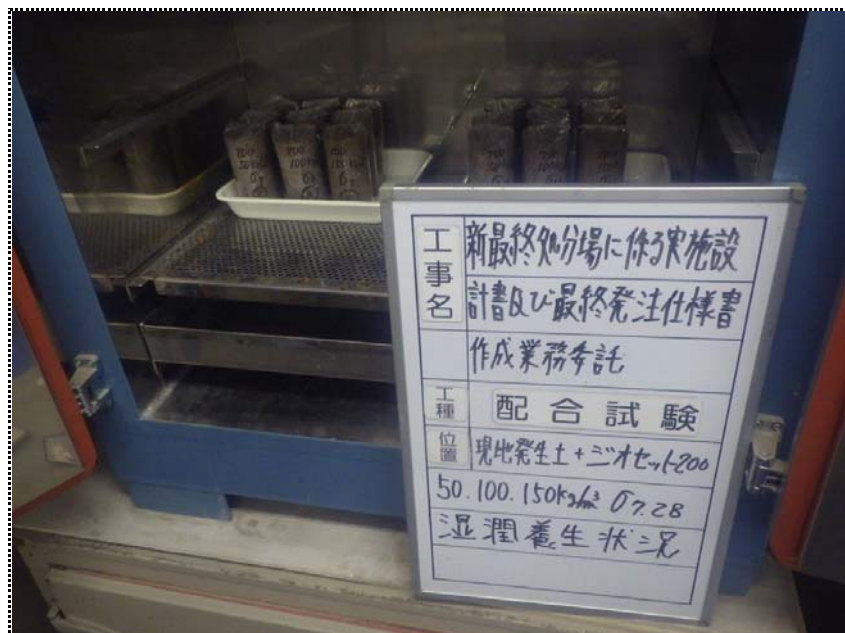
湿潤養生状況 50、100、150kg/m³
