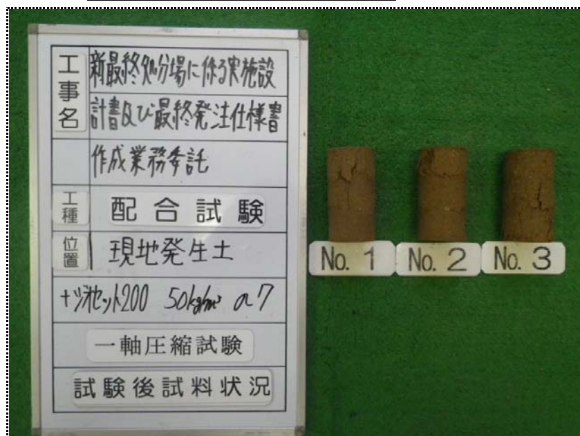
一軸圧縮試験 (試験後試料状況) 50kg/m³ (材令7日)
