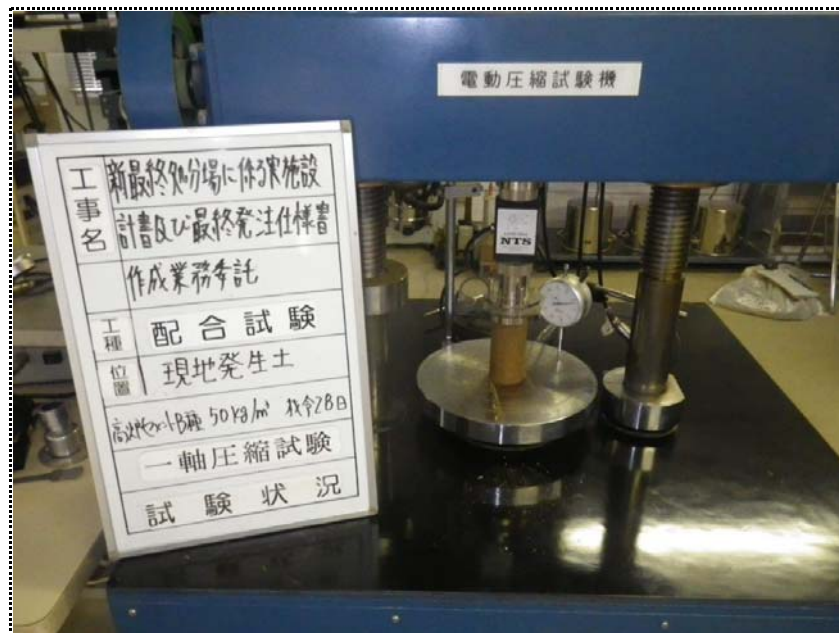
一軸圧縮試験（試験状況） 50kg/m³（材令28日）
