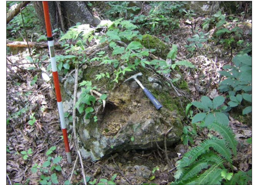
⑰ 集塊岩の岩塊。安山岩溶岩と集塊岩の岩塊が混在して見られる。
