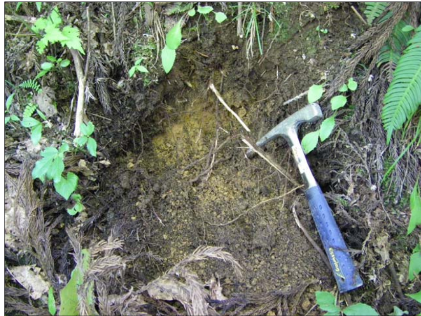
⑮ 淡黄褐色を示す粘性土の露頭。軟質である。
