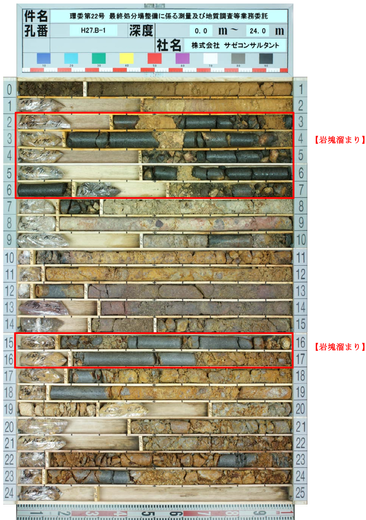
図6.1-6 ボーリングコア写真 (H27. B-1:No. 5, CL)
