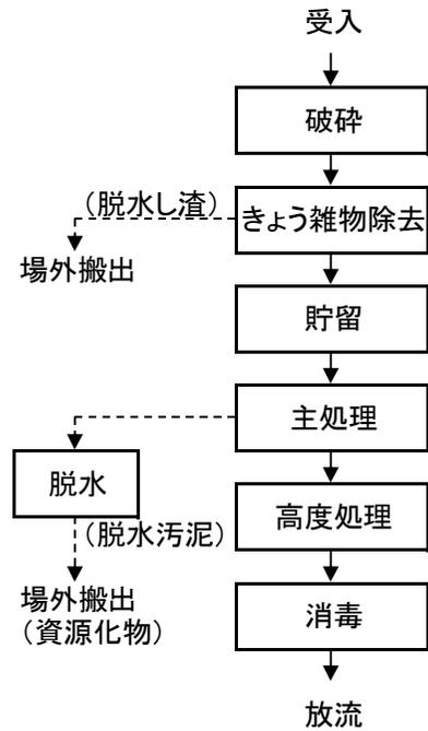
(2) 浄化槽汚泥の混入比率の高い脱窒素処理方式
