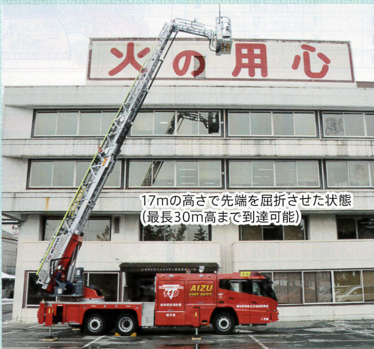
先端にある放水銃で毎分2,000リットルの放水が可能。はしごの伸縮、旋回に対応できる伸縮式水路を搭載することで、放水までの時間が大幅に短縮されました。
