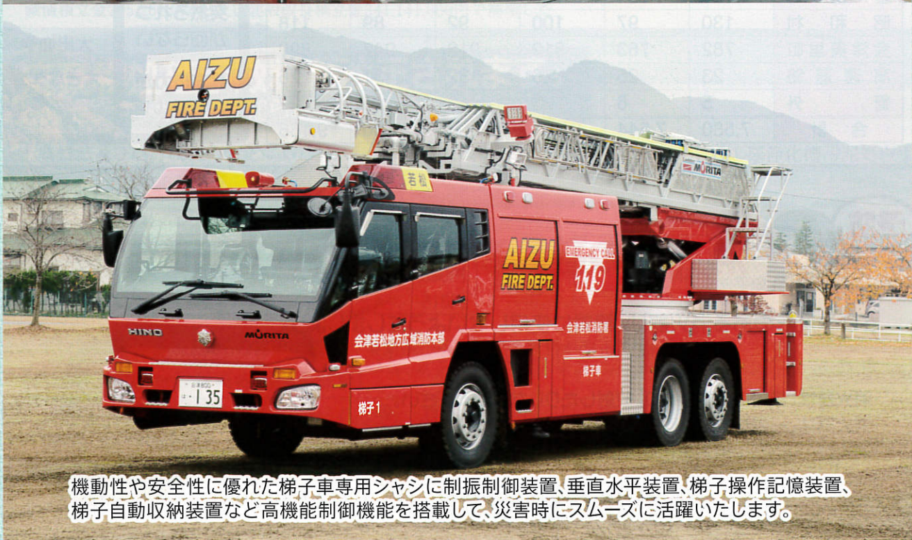
はしご先端部が屈折することで、障害物がある屋上でも安全確実な救助活動ができます。
